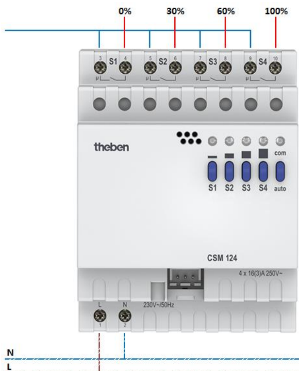
Abbildung 2: Anschlussplan Schaltmodul (Quelle: Theben)
